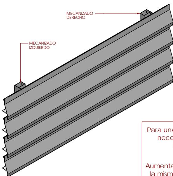
Para una distancia entre lamas de  $Y=0$ , necesitamos una distancia entre mecanizado de  $X=104$ .
